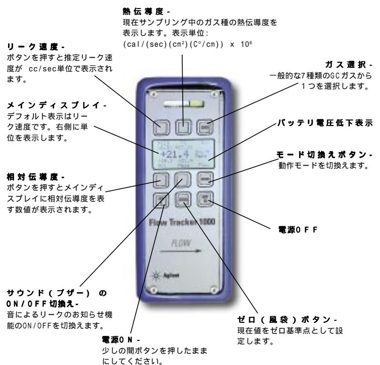
AgilentのFlow Tracker 2000 GCフローメータはガスの持つ熱伝導特性を利用してリークを検出します。一般的に、この方法でリークを検出できるのは測定対象となるガスの熱伝導度が空気に比較して明確に区別できる差(大きい/小さい)がある場合です。選択可能なガスの絶対熱伝導度( $80^\circ\text{F}$ 、 $26.7^\circ\text{C}$ )を次に示します。
